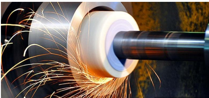
Prelucrarea prin polizare a interiorului piesei
