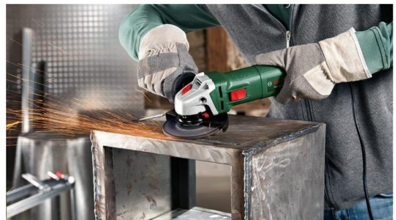
Polizarea cu polizorul unghiular
