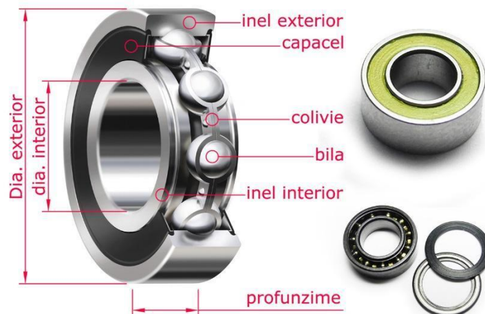
Fig. 2. Părțile componente ale rulmentului
