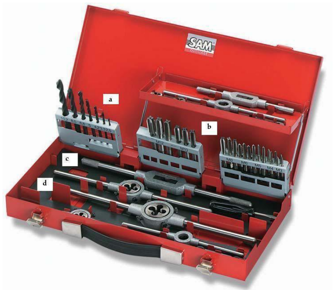
Set de scule utilizat la filetarea manuală (a-burghie; b-tarozi; c-porttarod; d-portfiliera)
