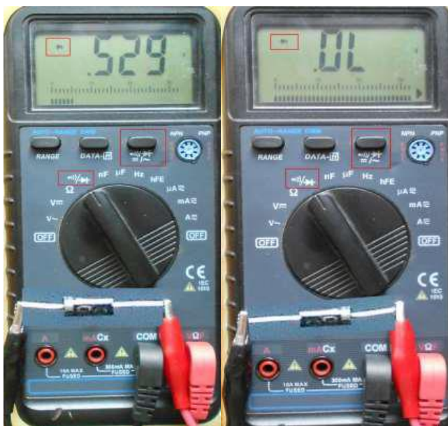
Figura 10. Măsurarea tensiunii pe joncțiunea diodei în ambele sensuri
