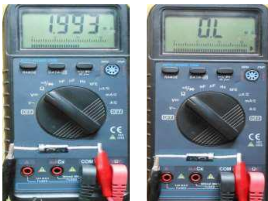
Figura 9. Măsurarea rezistenței joncțiunii diodei în ambele sensuri
